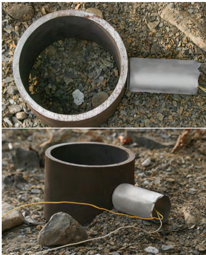
Abb. 1, 2: Behelfsmäßige Hohlladung (Kriegswaffe) vor einem Stahlrohr, Fotos: Schlöffel
